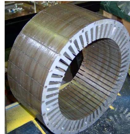
Per i motori ad alta efficienza' e' preferibile utilizzare i nuovi lamierini "premium steel" ad **alta "permeabilita' magnetica"** e **basse "perdite specifiche"** ( $P_{fe}$ ,  $I_{\mu}$ ).
